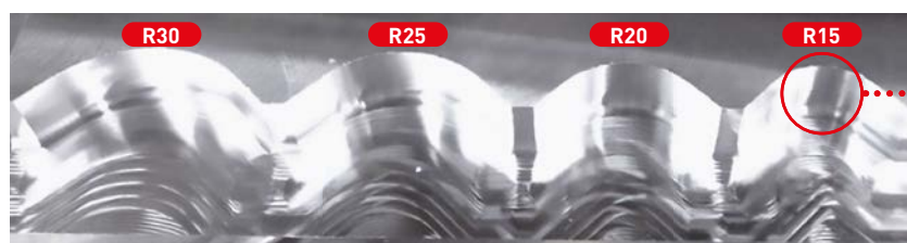
Vc = 200 m/min, R15, foto po obrábění
